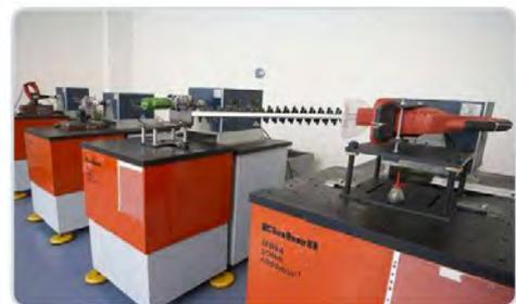
▲ Motorbremse - Dauerlaufprüfung
