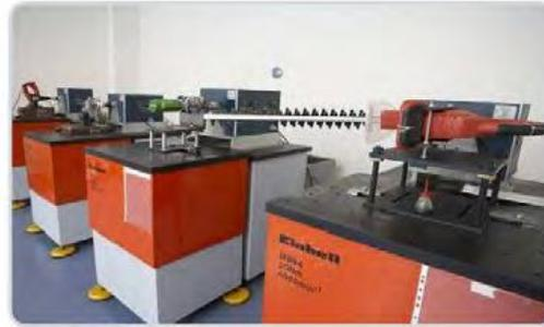
▲ Motorbremse - Dauerlaufprüfung
